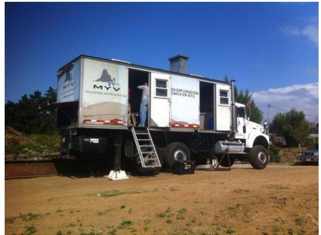
Fig. 12. 23 ton CPT truck.
